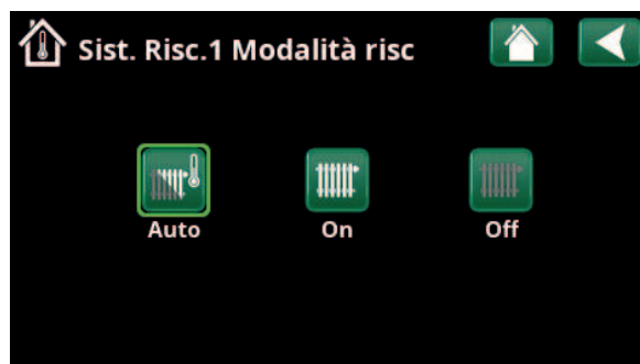
Menu “Circ. Risc. 1 Riscald./Raffresc./Circ. Risc. 1 Modalità riscaldamento” per il quale è stato attivato il modo “Auto”.
